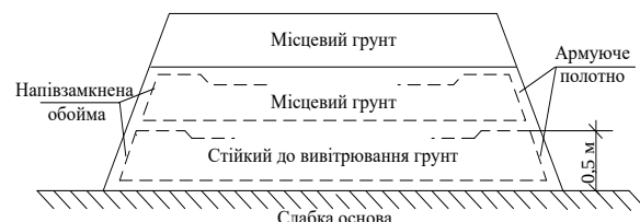
Рис. 2. Багатошарове армування насипу напівзамкненими обоймами [3]
