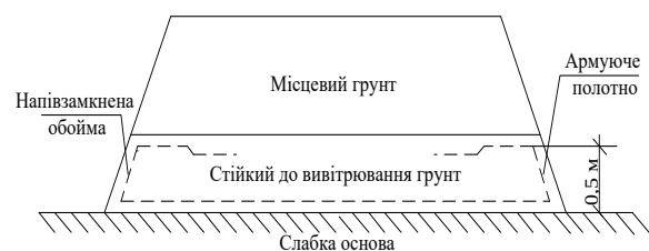
Рис. 1. Одношарове армування насипу напівзамкненою обоймою [3]
